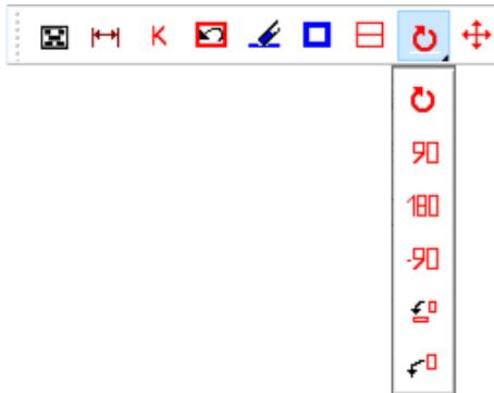
Рис. 65. Подменю поворота в панели инструментов **Размещение**
